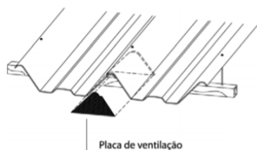
Figura 10: Detalhe placa de ventilação
